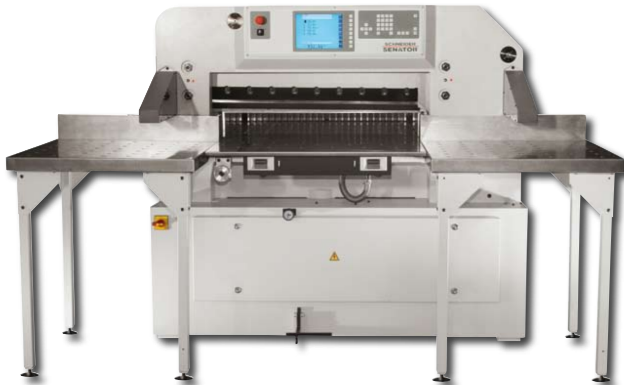
Die Abbildung oben zeigt die Maschine mit 2 Edelstahl-Seitentischen LST 750, luftdurchblasen, rostfrei
