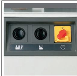
Die automatische Pressung lässt sich auch unabhängig vom Messer über die entsprechenden Drucktaster heben und senken.
