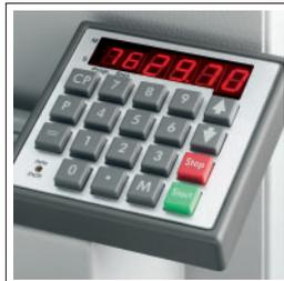
Der Rückenschlag kann über die „EP“-Steuerung per Maßdirekt-eingabe, über die Memory-Funk-tion oder im Programmbetrieb positioniert werden.
