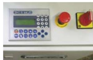
DESTA Digitalsteuerung zur flexiblen Anpassung an alle Falzmaschinen
